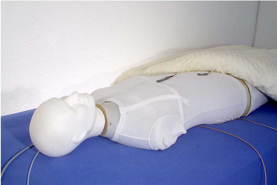
Abb.7a: Klima-Dummy zur mikroklimatischen Untersuchung von Matratzen
